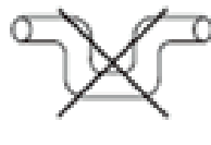
Zbyt wiele gięć przewodu wentylacyjnego
